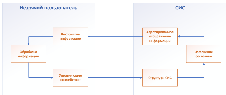
Рис. 2. Схема взаимодействия незрячего пользователя с СИС
